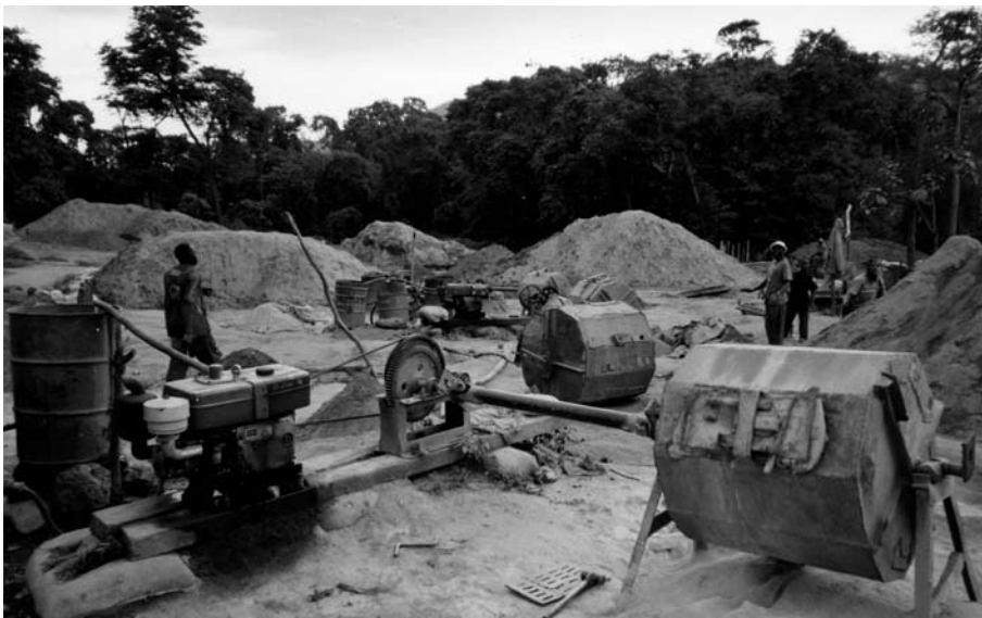
Halvhårt material eller sten som rostats körs också i hemmagjorda stenkrossar eller snarare tumlare för att få fram guldbärande sand.
